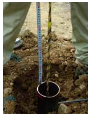
落下高さ確認
